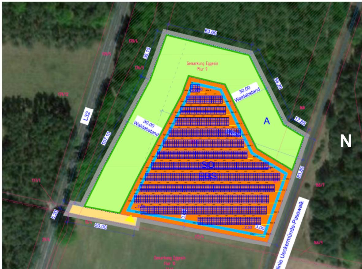
Abbildung 1: Satellitenbild mit Modulbelegungsplan des Anlagenstandortes
