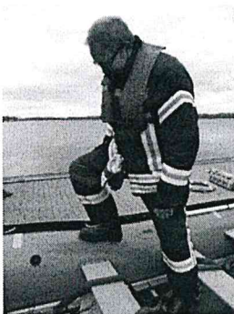
Abb. 10: Formbeständigkeit des Bootes bei Belastung
