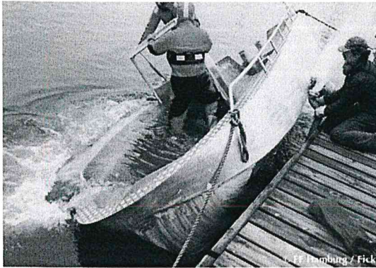
Abb. 12: Kenterversuch mit einem Neubau
