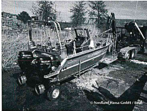
Abb. 14: Absetzen mit Wechsellader
