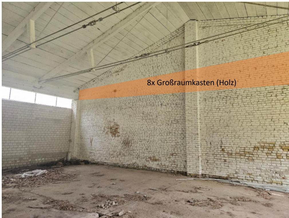
Abbildung 2: Innenansicht Gebäude Nr. 1, nördliche Giebelwand. Hier können an beiden Giebelwänden je 8 Großraumkästen (Holzbauweise) angebracht werden (orange markiert). Die Kästen können direkt nebeneinander, ohne Abstand, montiert werden.
