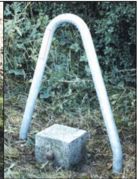
HFP Granitpfeiler 25 cm x 25 cm mit seitlichem Bolzen und Stahlenschutzbügel
