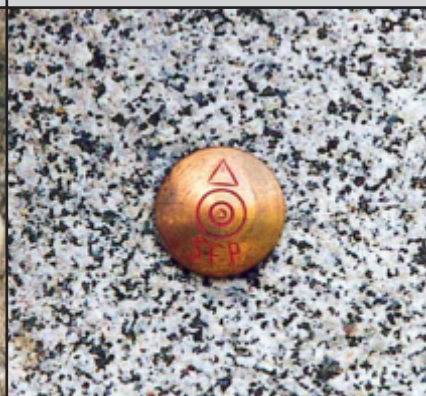
SFP Messingbolzen Ø 3 cm
