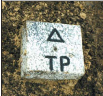
BFP/TP Granitpfeiler 16 cm x 16 cm (auch bodengleich)*
